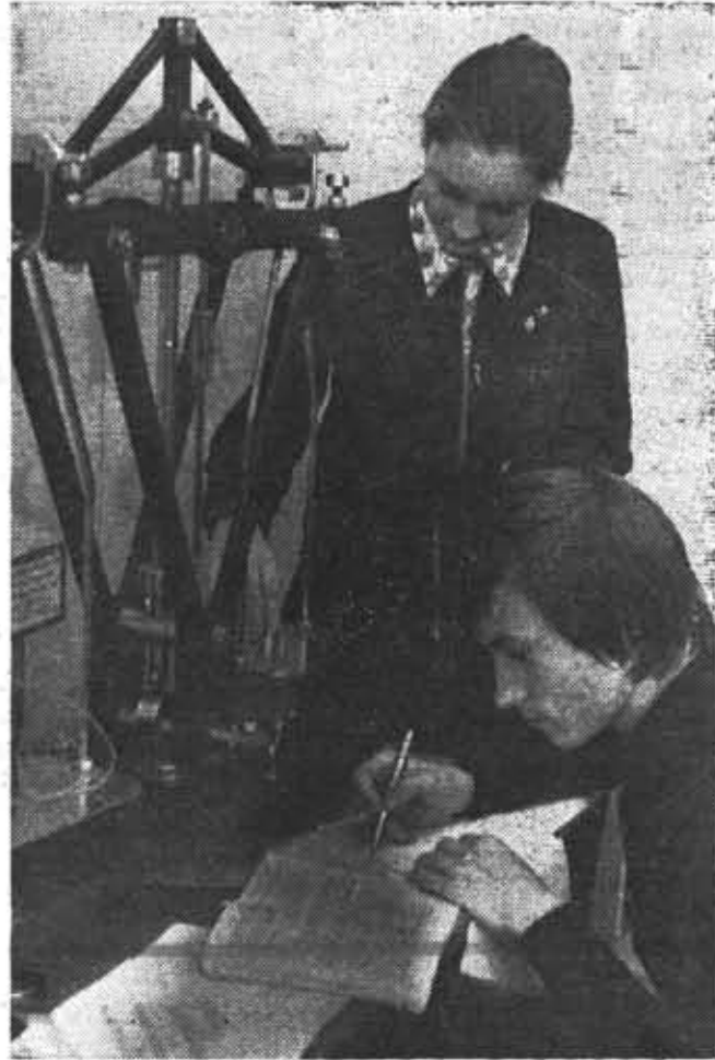
Учебные будни первокурсников. Студенты 145-й группы Ольга Архипова и Николай Крупин выполняют лабораторную работу на занятиях по физике, определяя момент инерции твердого тела. Фото З. Степановой
