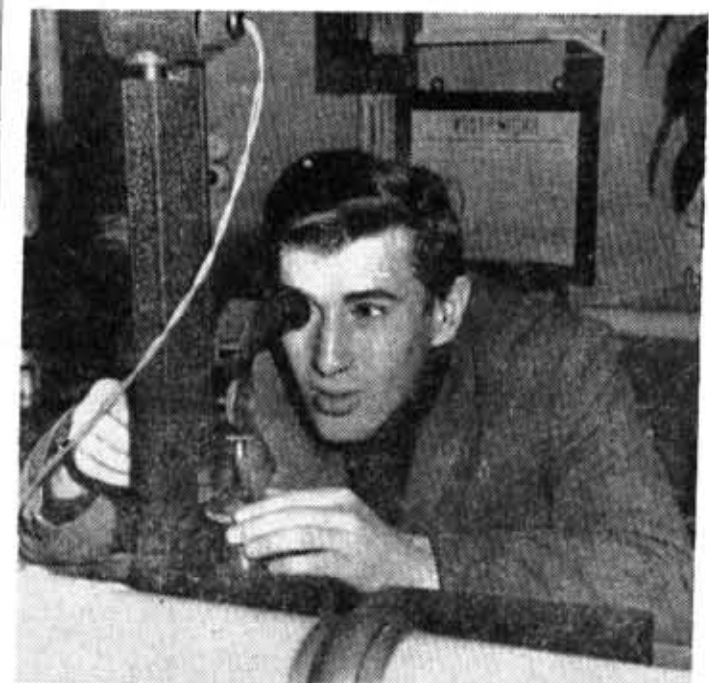
Лабораторные занятия на кафедре теории оптических приборов. Студент 436-й группы Борис Ройтман контролирует центровку линз.
