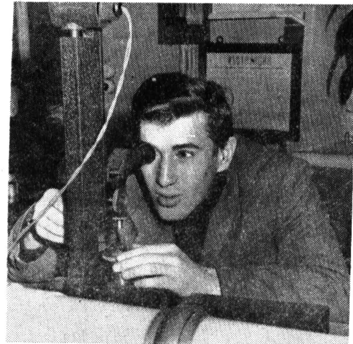
Лабораторные занятия на кафедре теории оптических приборов. Студент 436-й группы Борис Ройтман контролирует центровку линз.
