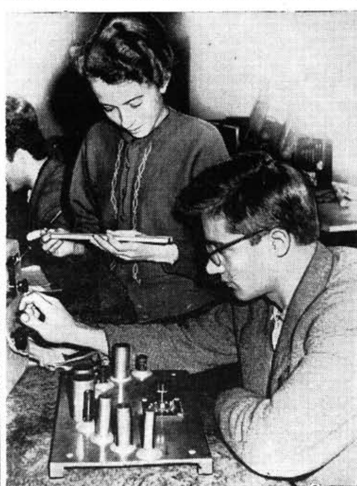
Не простое это дело — исследование катушек индуктивности. Внимательно следят за показаниями приборов и производят расчеты студенты 485-й группы О. Панченко и Э. Бернштейн. Фото З. Степановой
